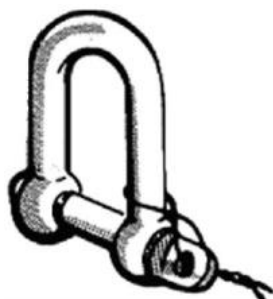
Fig. 26 - Manilha com troço trancado com um fio Fonte: FAO 593
