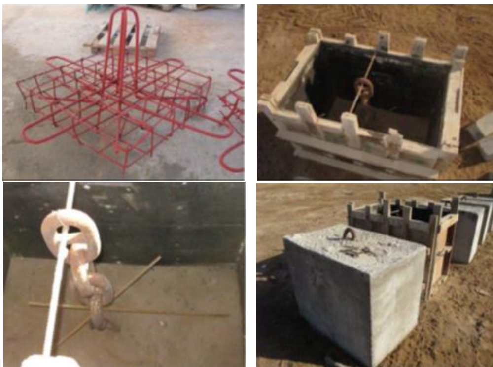
Fig. 17 – Poita e seu processo de fabrico
